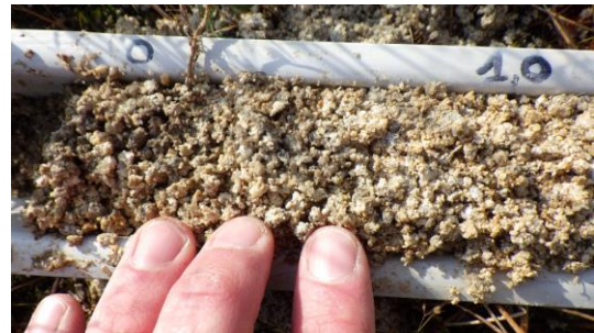
Sondage n°1 – vue de détail (arènes granitiques blanchâtres)
