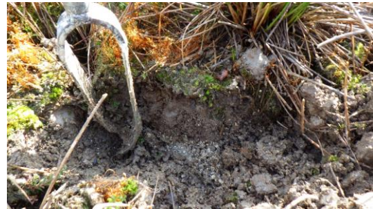
Présence des arènes granitiques et du substratum rocheux au-delà de 10 à 15 cm de profondeur – sondages 4, 5, 6 et 7
